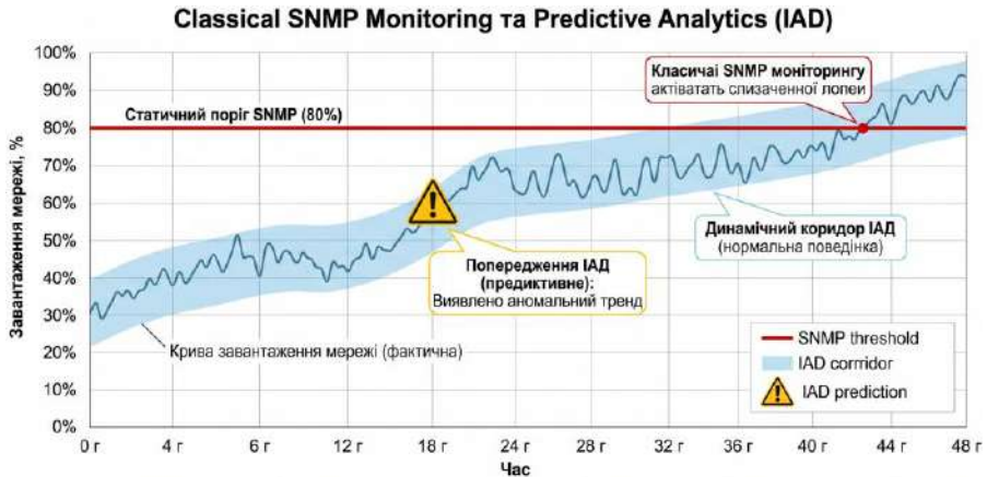
Рис. 2. Графік порівняння класичного SNMP-моніторингу та предиктивної аналітики ІАД
