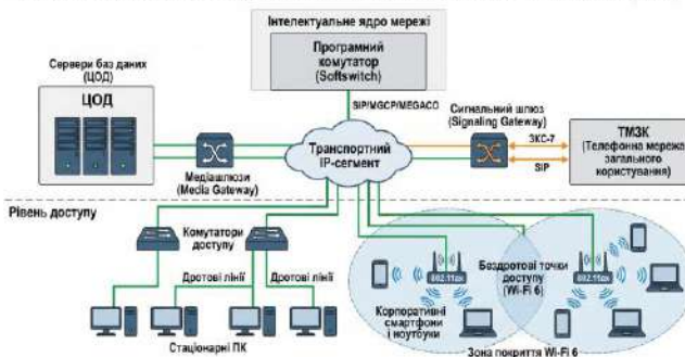
Рис. 1. Структурна логічна схема сучасної корпоративної мультисервісної мережі (NGN)
