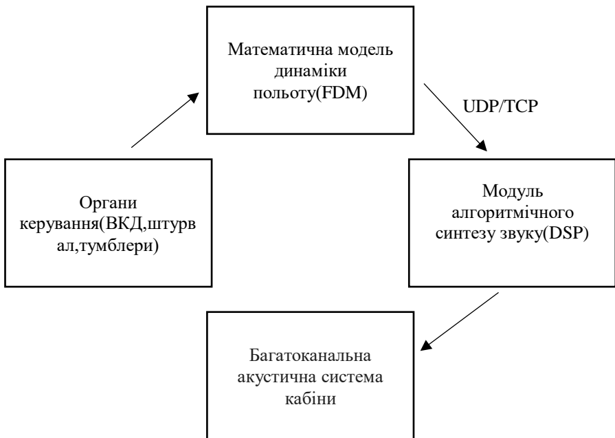
Рис. 1. Структурна схема алгоритмічного синтезу акустичних сигналів в ІКС тренажера
