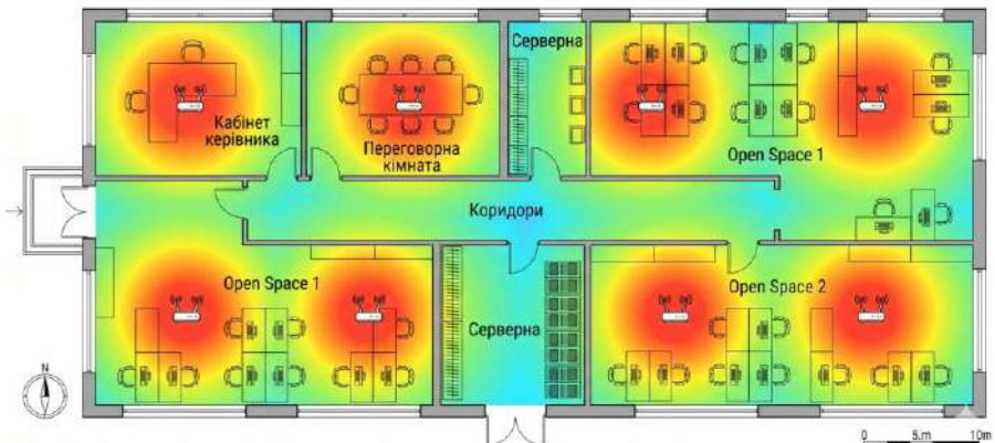
Рис. 2. карта (Heatmap) радіопокриття Wi-Fi в одноповерховому офісі підприємства площею близько 500 м 2
