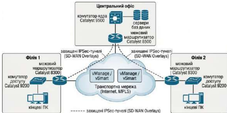
Рис. 1. Структурна схема взаємодії центрального офісу та філій у межах КМ на базі Cisco SD-WAN
